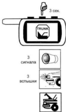
Дополнительный канал №1 (желто-черный провод) может быть активизирован независимо от состояния сигнализации и использован для дистанционного отпирания багажника. Если канал активизирован при включенном режиме охраны, то зоны багажника и датчика удара временно отключаются.
