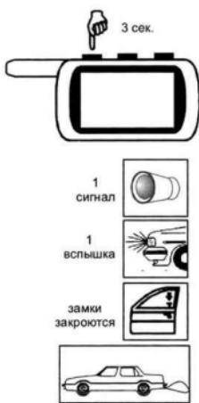
В сигнализации предусмотрена возможность включения режима охраны при работающем двигателе. Это может быть необходимо при кратковременной остановке или при стоянке в холодное время года.
