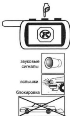
**Способ 1** - при включенном зажигании с помощью кнопки 3 брелка установите курсор на иконку и нажмите кнопку 2 брелка. На дисплее брелка появится иконка , прозвучит короткий звуковой сигнал.
