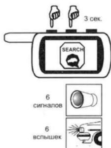
В этом режиме система подает 6 звуковых сигналов и 6 вспышек габаритов, облегчающих поиск автомобиля в темное время суток. Брелок подаст мелодичный звуковой сигнал.
