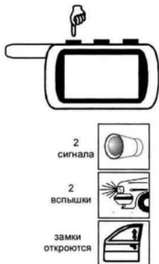
Для выключения режима охраны нажмите кнопку 1 брелка, предварительно запрограммировав ее для включения/выключения режима охраны с тихими сигналами подтверждения.
