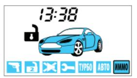
Блокировка двигателя отключена
