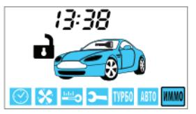
Двигатель разблокирован, режим охраны выключен
